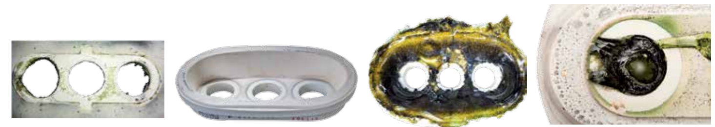
Orifice rings insertados para larga duración en vidrios blanco, ámbar y verde
