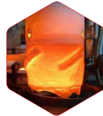
● Tube rotor: durée de vie de 4 à 15 mois
