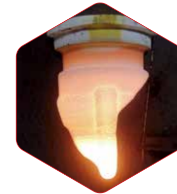
● Segment de rotor: durée de vie de 6 à 9 mois
