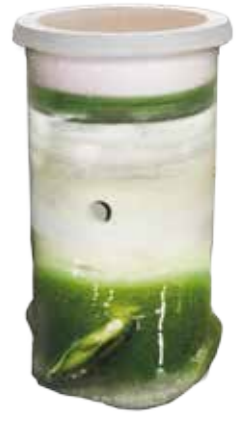
● Selon la température de la coulée, la couleur du verre, la capacité de production de la ligne et la vitesse de rotation, la durée de vie prévue est de 4 à 15 mois
