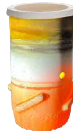
● Selon la température de la coulée, la couleur du verre, la capacité de production de la ligne et la vitesse de rotation, la durée de vie prévue est de 4 à 15 mois
